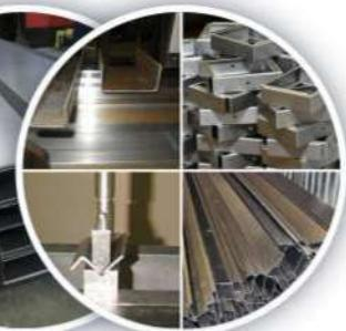
Гибка листового материала - это "холодная" технология обработки. Она дает возможность обойтись без сварочного шва, что позволяет получить более точное и качественное изделие. В сочетании с 3D моделированием наша компания может изготовить даже самые сложные изделия.
